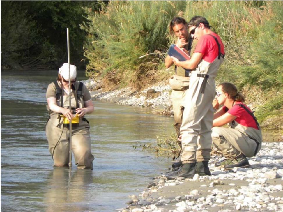
*Abb. 3.5: Vermessung der Wassertiefe und Fließgeschwindigkeit mit Messlatte und Flomate*
