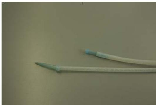
**Abbildung 2.5:** Ansaugvorrichtung und Mundstück des Exhaustors
