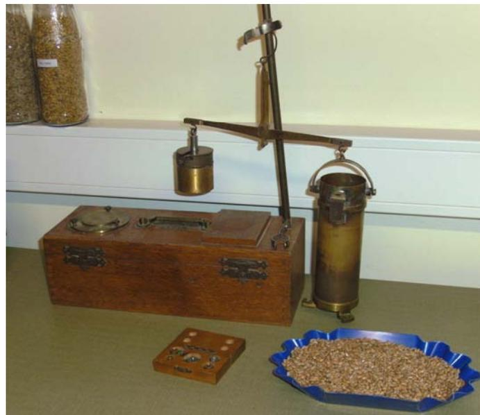
Foto 2: Gerät zur Bestimmung des Hektolitergewichtes
