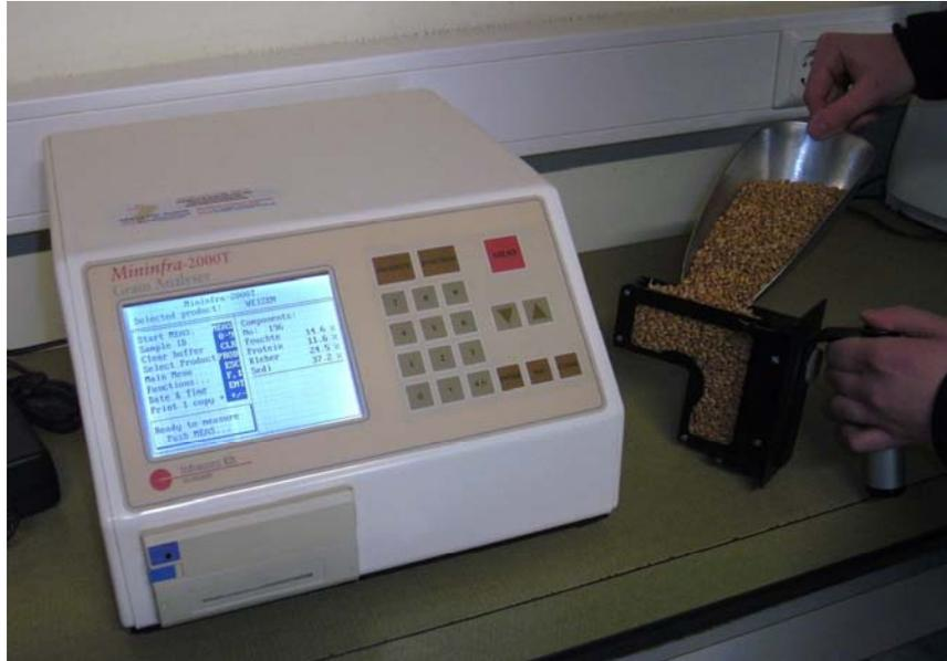
Foto 3: Gerät zur Messung des Proteingehaltes
