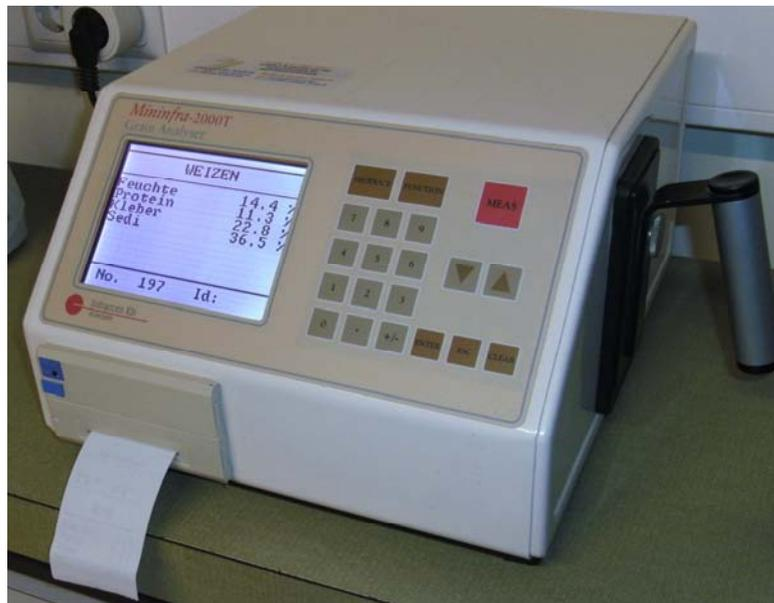
Foto 4: Gerät zur Messung des Proteingehaltes
