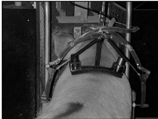
**Abb. 5:** Prototyp einer automatischen Einrichtung zur Speckdickenmessung am Brei-Nuckel (HESSE, 2003)
