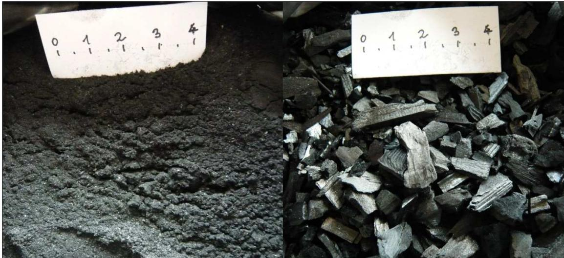
Abbildung 3.1: Fraktion < 0,63 mm (links), Fraktion 2-8 mm (rechts), Maßstab in cm
