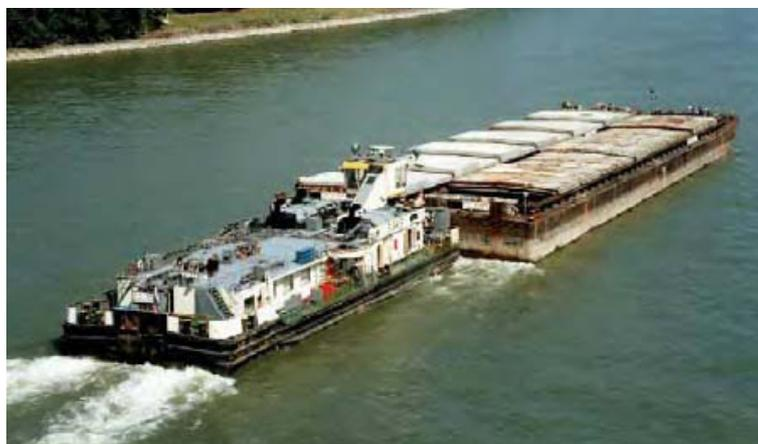
Abbildung 3: Schubverband mit zwei Leichtern (VIA DONAU, 2005, a50)
