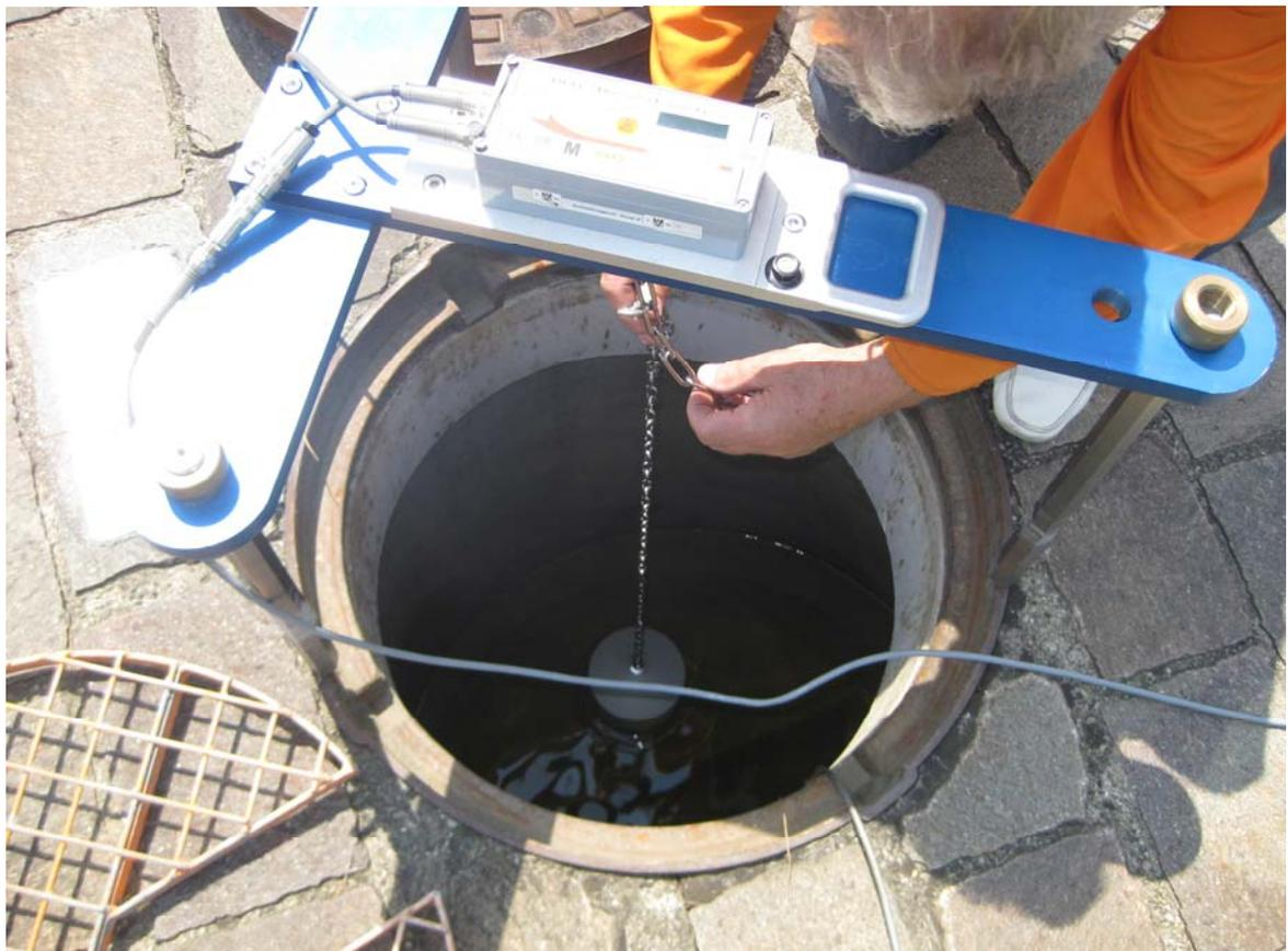
Abbildung 11: Pegelmessgerät DLG, Ser. Nr.: 001 (Ausführung: Gewichtswaage mit Eintauchkörper)
