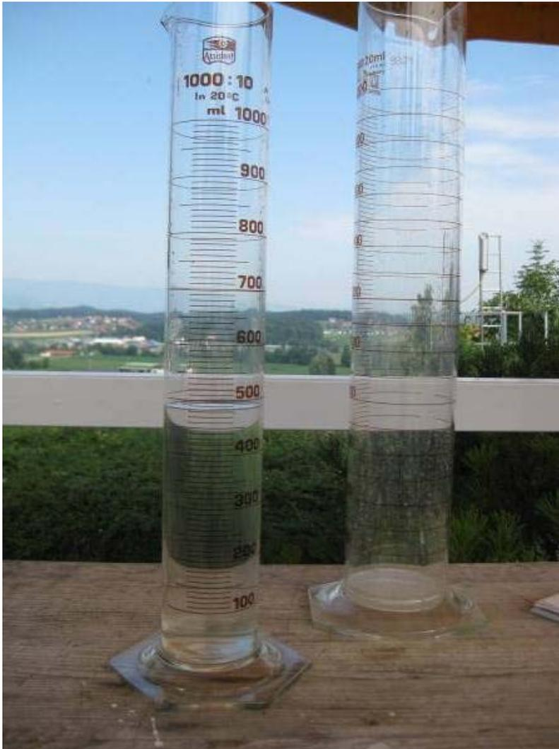
Abbildung 18.: Bestimmung der ausgetretenen Wassermenge mittels Messzylinder
