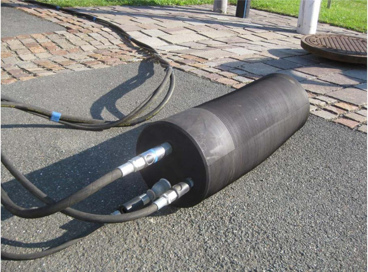
Abbildung 15.: Angeschlossenes Dichtkissen (Prüfdichtkissen) für die Prüfung mit Luft
