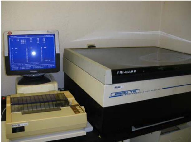
**Abbildung 12:** Scintillationszähler Tri-Carb 2500 TR zur Messung der Enzymaktivität
