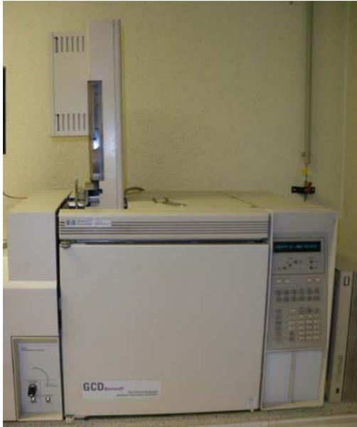
**Abbildung 17:** GC-MS von Agilent (GCD) mit automatischem Probengeber.
