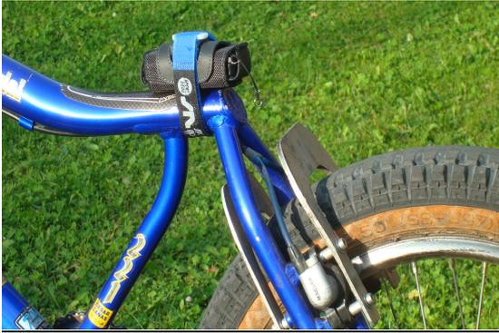
Abbildung 4-1: Messeinheit am Oberrohr des Fahrrades
