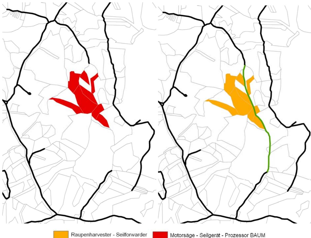
Abbildung 64: Bestgeeignete Erntesysteme vor und nach Verbesserung der Erschließung
