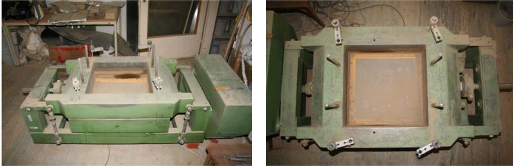
Abbildung 2.14: Großrahmenschergerät mit einer möglichen Probengröße von 50 x 50 cm. Der untere Rahmenteil ist beweglich während der obere fixiert ist. Institut für Geotechnik, Boku Wien.
