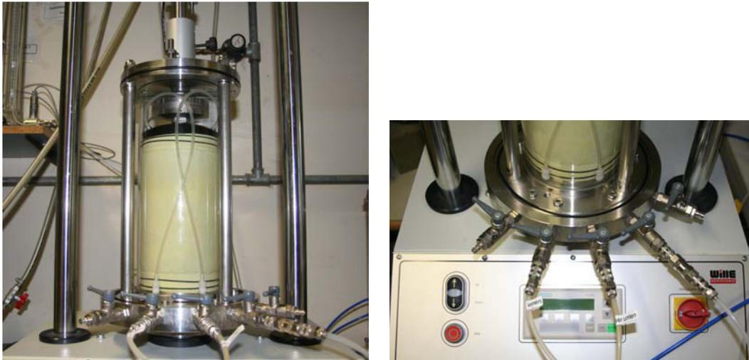
Abbildung 2.17: Druckzelle des Triaxialversuchs mit den Steuerventilen. Institut für Geotechnik, Boku Wien.
