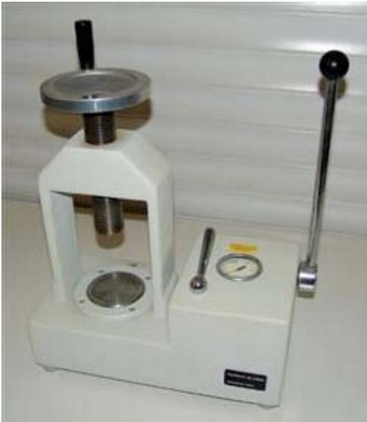
**Abb. 4.2: Hand-Hydraulische Presse von Perkin-Elmer**
