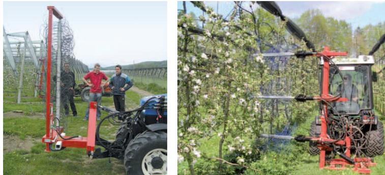
Abbildung 1: links: Ausdünngerät Tree Darwin; rechts: Ausdünngerät Typ Bonn (LAFER, 2009)
