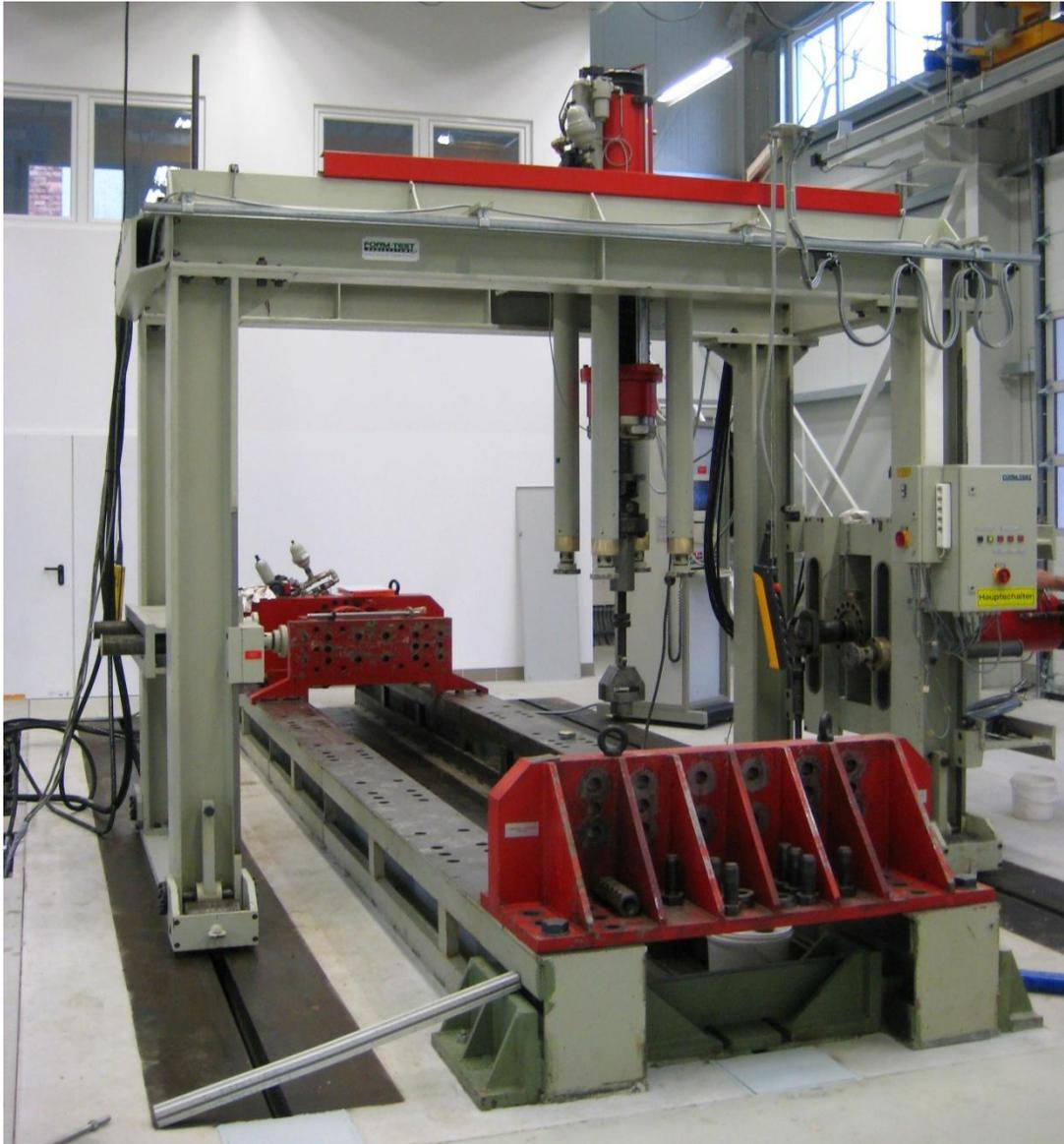
Abb. 29 Servohydraulische Prüfmaschine am Institut für konstruktiven Ingenieurbau, Wien
