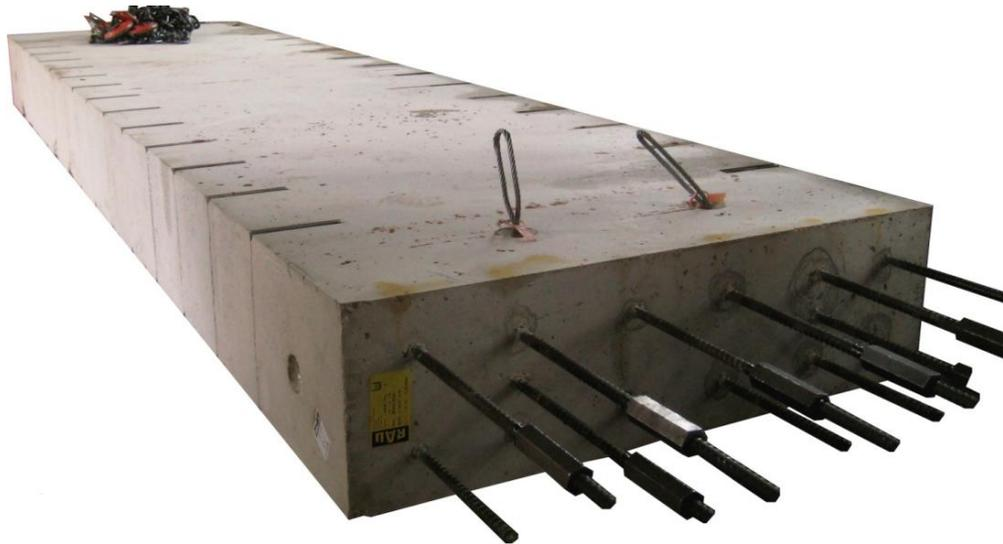
**Abb. 23** Prüfkörper zur Durchführung von Auszugsversuchen in gerissenem Beton
