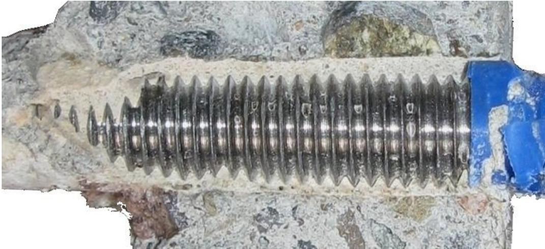
**Abb. 10 Verbundanker, Injektionssystem. Verändert aus [22]**
