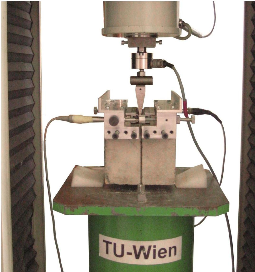
Abb. 28 Einaxiale Prüfmaschine mit aufgebaitem Keilspaltversuch an der TU-Wien
