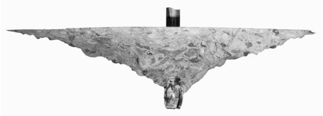
**Abb. 13** Typischer Ausbruchkegel bei Betonversagen
