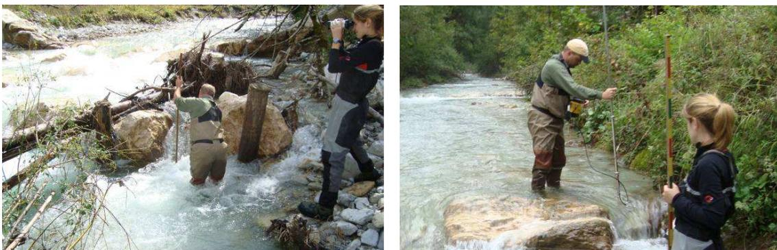
Abb. 35: Kartierung der Schwellen im Johnsbach mittels Messung der Breite, Absturzhöhe und Fließgeschwindigkeiten.
