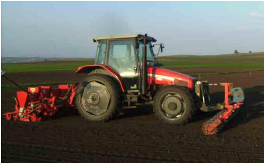
Abbildung 3: Aussaat mit pneumatischer Einzelkornsämaschine
