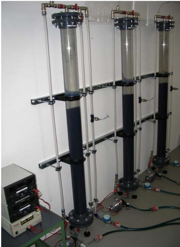
Abbildung 14 Technikversuch zur katalytischen Entmanganung im Filterbett
