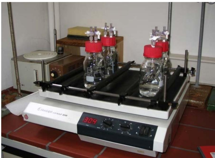
Abbildung 22 Proben auf dem Horizontalschüttler bei 304 U/min
