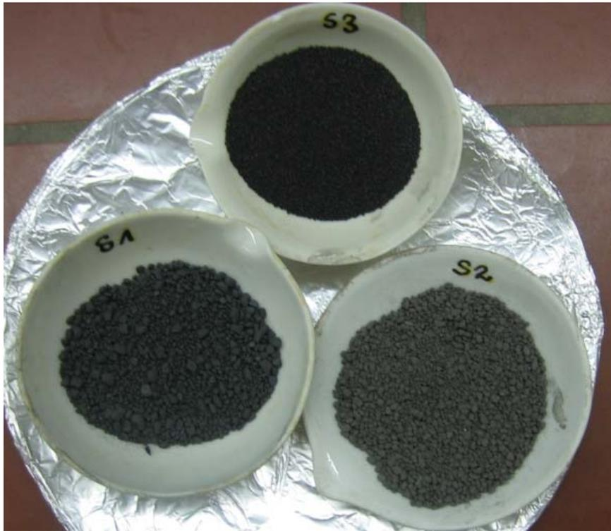
Abbildung 13 Die getesteten Filtermaterialien: Hydrolit-Mn (S1), Birm (S2), Catalox (S3)
