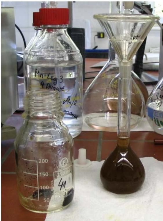
Abbildung 19 In einem 100 ml Messkolben wurde die extrahierte Lösung von drei Durchgängen gesammelt. In der Glasflasche befindet sich das Filtermaterial Catalox, von dem das sorbierte Mangan mit Hilfe einer Bariumchloridlösung wieder desorbiert wurde.
