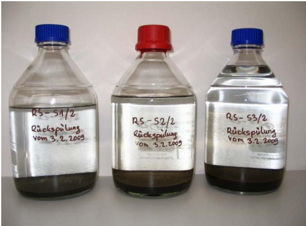
Abbildung 17 Sammelproben der 2.Rückspülung am 03.02.2009 (Versuchsphase 2); Schlamm aus 50 l Rückspülwasser als Resultat von einer Woche Betrieb von Säule 1 (Hydrolit-Mn), Säule 2 (Birm) und Säule 3 (Catalox) (von links nach rechts); (Die Masse der Rückspülschlämme beträgt filtriert und getrocknet ca. 1 g)
