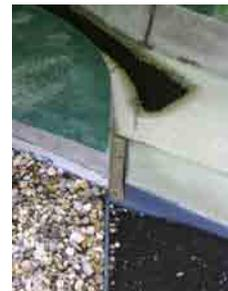
**Abbildung 6-6 Geschiebegasse der Optimalen Variante - HQ1**
