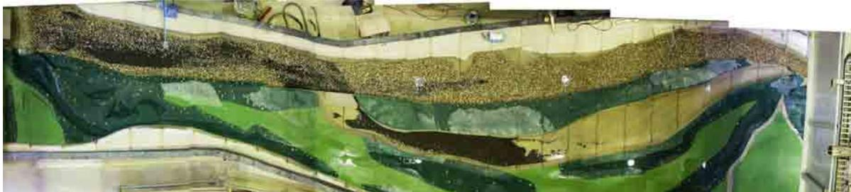
**Abbildung 6-9 Geschiebeablagerungsbild der optimalen Variante HQ10**
