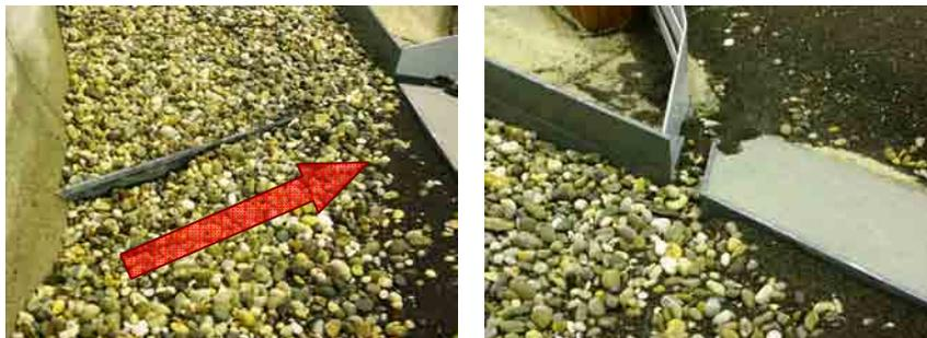
Abbildung 5-41 Umlagerung der Flusssohle
