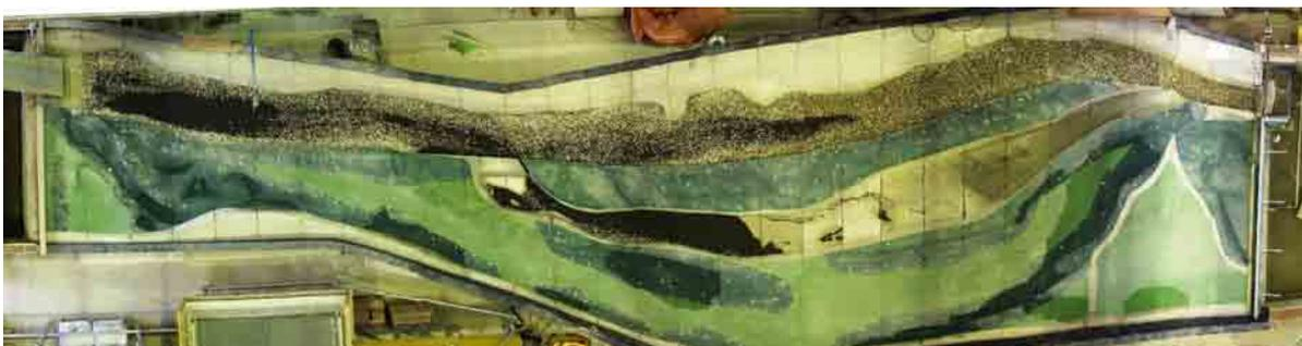
**Abbildung 6-11 Geschiebeablagerungsbild der optimalen Variante HQ10**
