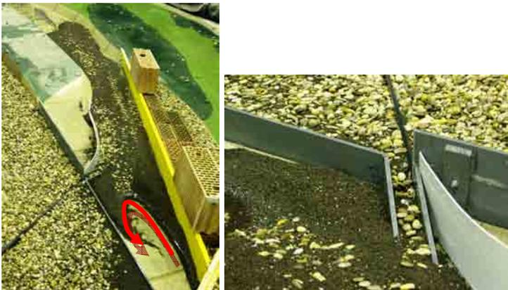
Abbildung 5-31 Einlaufbereich Variante 10 – Kehrströmung
