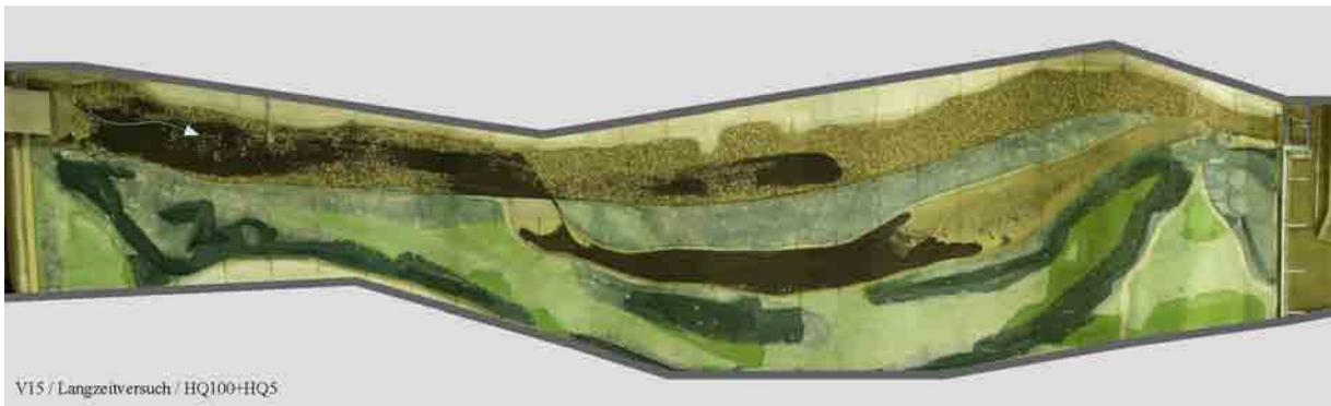
**Abbildung 6-17** Geschiebeablagerungsbild bei Langzeitversuch HQ100+HQ5
