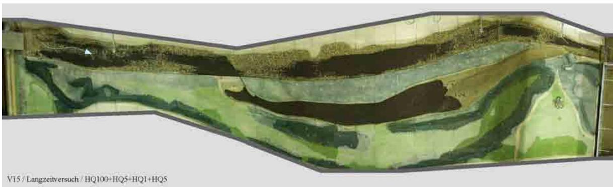
**Abbildung 6-19** Geschiebeablagerungsbild bei Langzeitversuch HQ100+HQ5+HQ1+HQ5
