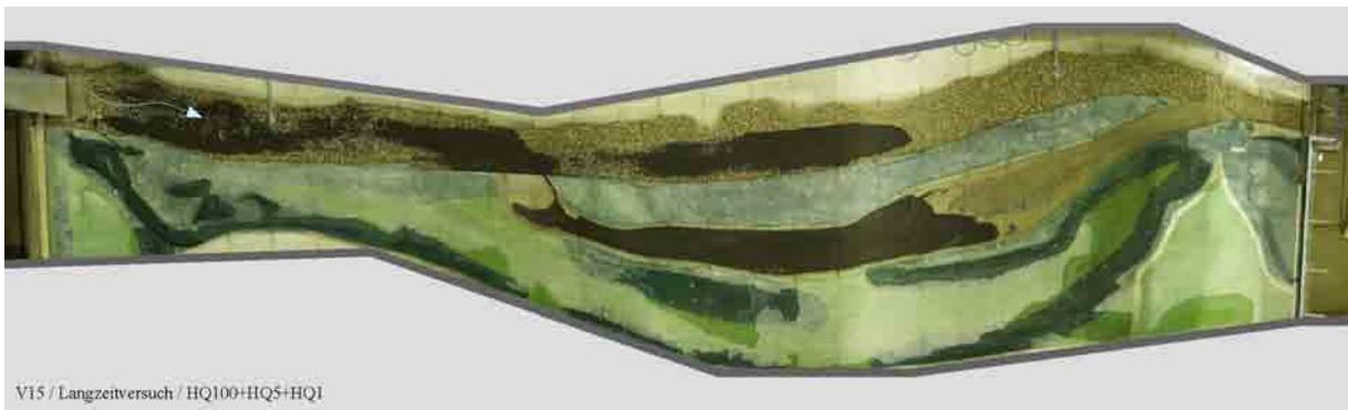
**Abbildung 6-18** Geschiebeablagerungsbild bei Langzeitversuch HQ100+HQ5+HQ1
