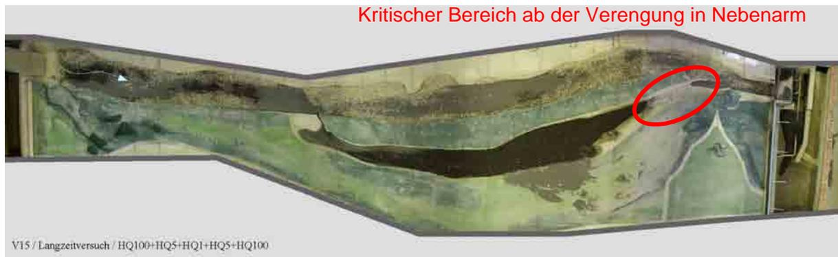
**Abbildung 6-20 Geschiebeablagerungsbild bei Langzeitversuch HQ100+HQ5+HQ1+HQ5+HQ100**
