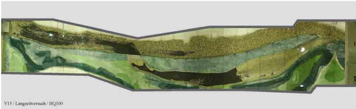
**Abbildung 6-16** Geschiebeablagerungsbild bei Langzeitversuch HQ100
