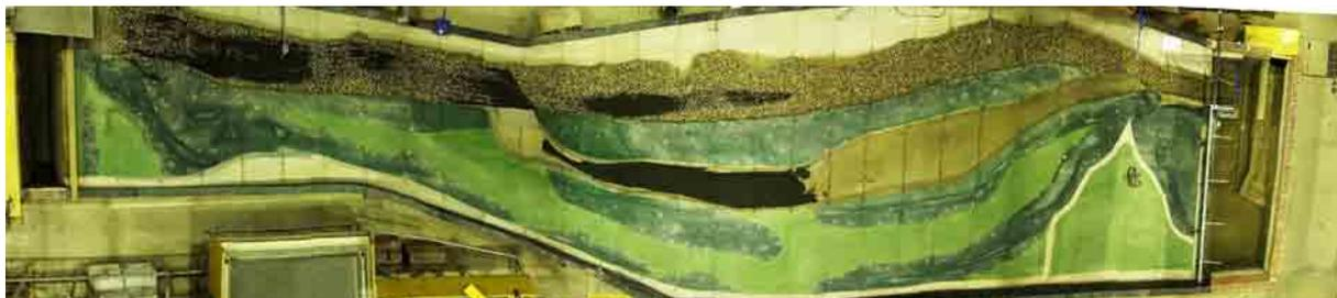
**Abbildung 6-7 Geschiebeablagerungsbild der optimalen Variante HQ1**
