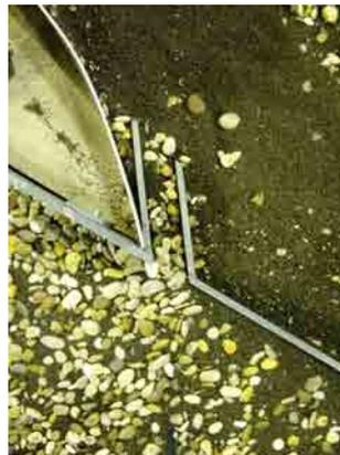
Abbildung 5-36 und 5-37 Komplette Verstopfung der Geschiebegasse und Verlandung des Streichwehrs
