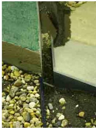
**Abbildung 6-2 Geschiebegasse der optimalen Variante**
