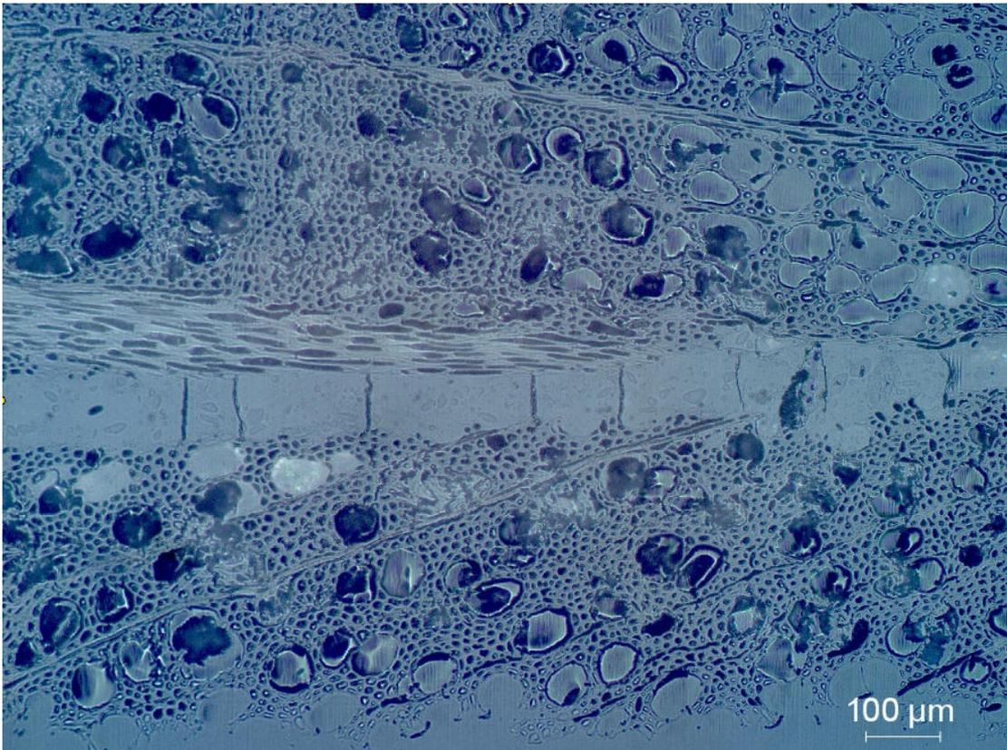
**Abb.20:** Auflichtmikroskopische Aufnahme einer unverstärkten UF-Leimfuge
