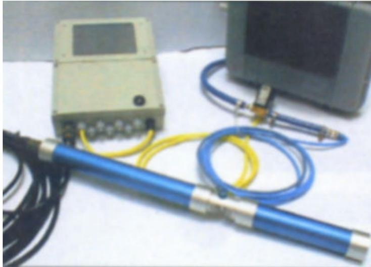
**Abbildung 10: UV/VIS-Spektrometer**
