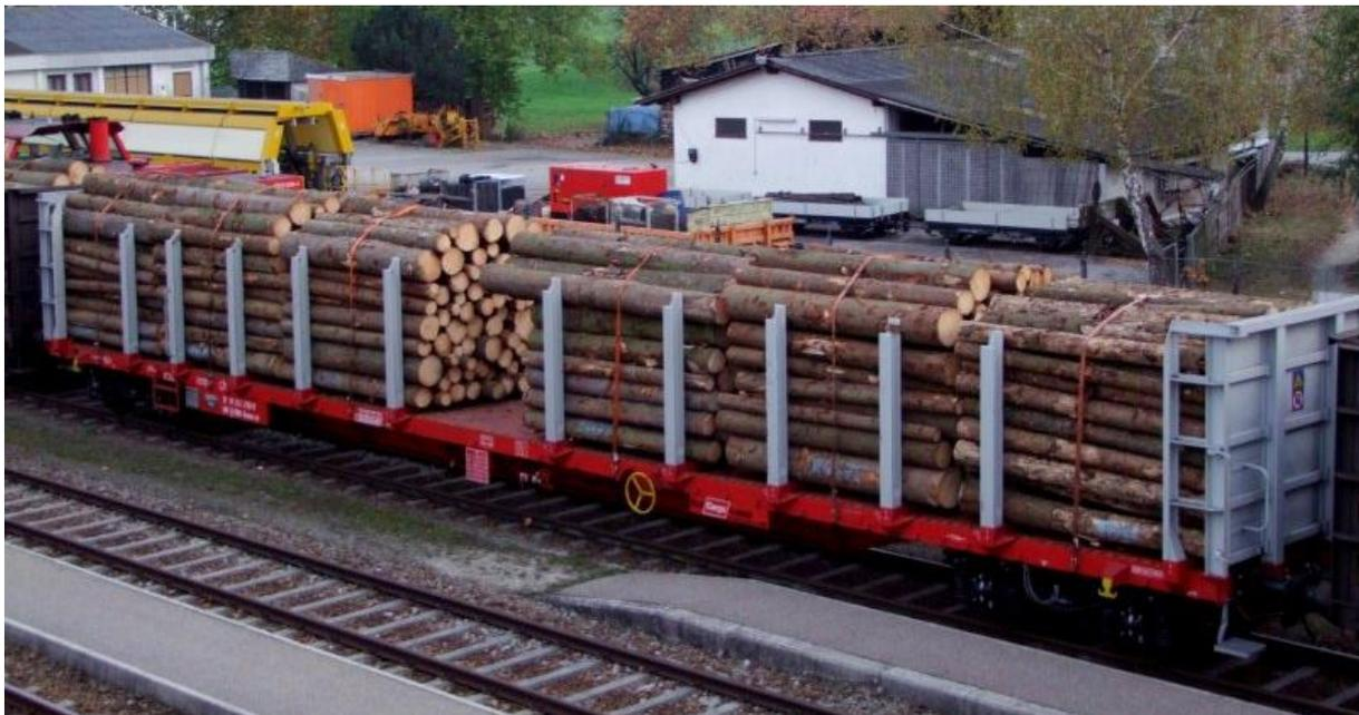
Abbildung 22: Bahntransport von Rundholz mittels Rungenwaggon, Waggontyp *Rnoos-uz* (Quelle: [Bahnbilder.de](http://Bahnbilder.de), 2008)
