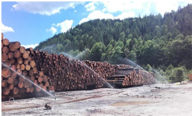
Abbildung 41: Betrieb eines Nasslagers (Quelle: BMK Infothek, 2020a)
