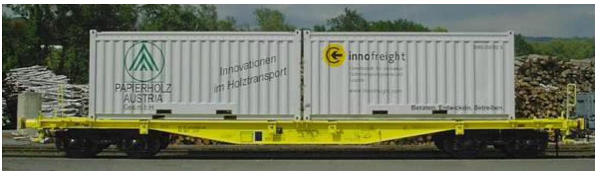
Abbildung 17: WoodTrainer zur Beförderung von Schüttgut und Biomasse (Quelle: Innofreight Solutions GmbH, 2021)
