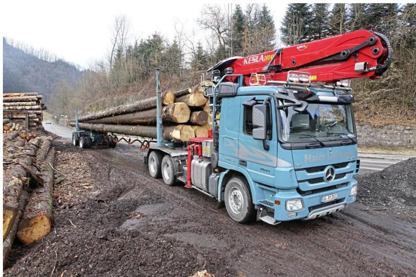
Abbildung 12: Beispiel eines LKWs mit Aufbauart 17 Langholz (Quelle: forstpraxis.de, 2018)
