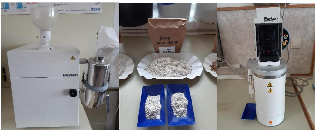
Abbildung 16: Messung der Fallzahl: (i) Labormühle Typ 3100, (ii) vermahlene Roggenprobe, (iii) Gerät zur Bestimmung der Fallzahl nach Hagberg (v.l.n.r.)
