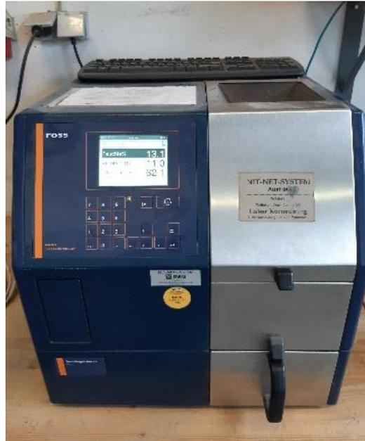
Abbildung 14: Nah-Infrarot-Transmissions-Spektroskopie (NITS) Foss Infratec Typ 1241
