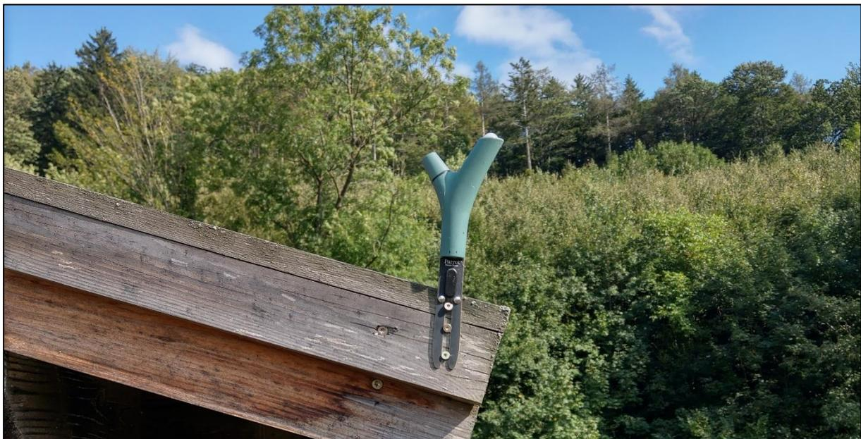
Abbildung 4.10: "Flower Power®"-Gerät zur Messung der Sonneneinstrahlung an Messhütte MS
