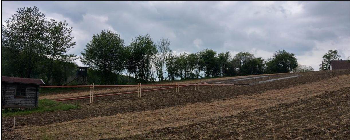
Abbildung 4.7: Aufbau des Versuchsstandortes mit Plot, Auffangrinne, Ableitung und Messhütte
