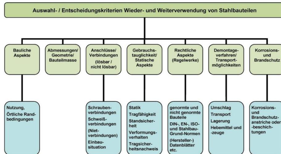
Abb. 10: Auswahl- und Entscheidungskriterien für die Wiederverwendung von Stahlbauteilen (Dechantsreiter et al., 2015b).
