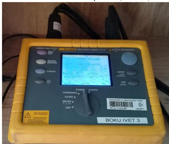
Abbildung 11 - Fluke 1735 Power Logger (eigene Darstellung 2018)
