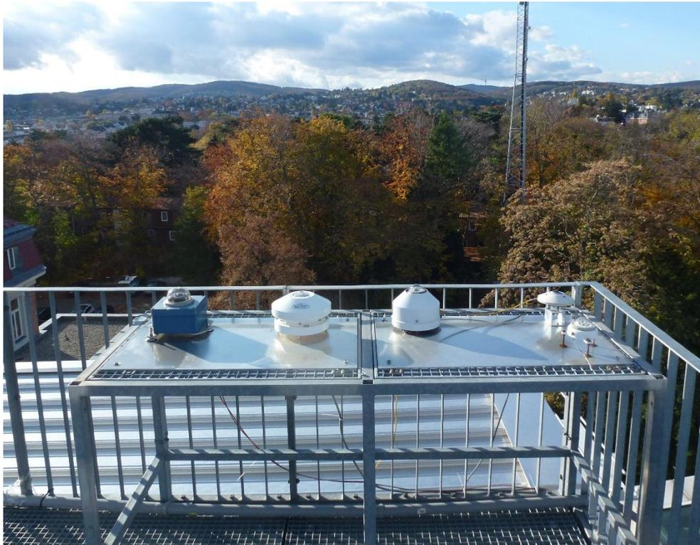
Abbildung 14 - Wetterstation BOKU mit den beiden Pyranometern (BOKU 2018)
