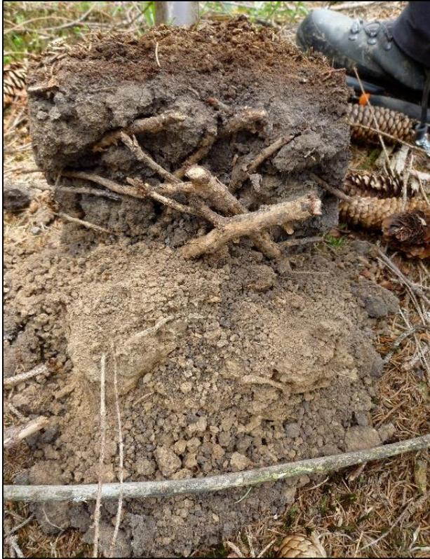
Abb. 16: Spatenprobe im Bestand I mit Humusauflage und Ah<sub>b</sub>-Horizont
