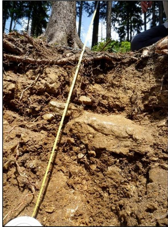
Abb. 17: Bodenprofil des Bestand I: Pseudovergleyter Kalklehm mit nach unten stark zunehmendem Skelettanteil. Aus diesem Profil wurden Bodenproben aus jedem Horizont für die Korngrößenanalyse gewonnen
