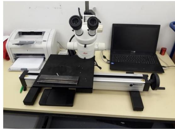
Abb. 5. Digitalpositioniergerät zum Vermessen des Radialzuwachses.
