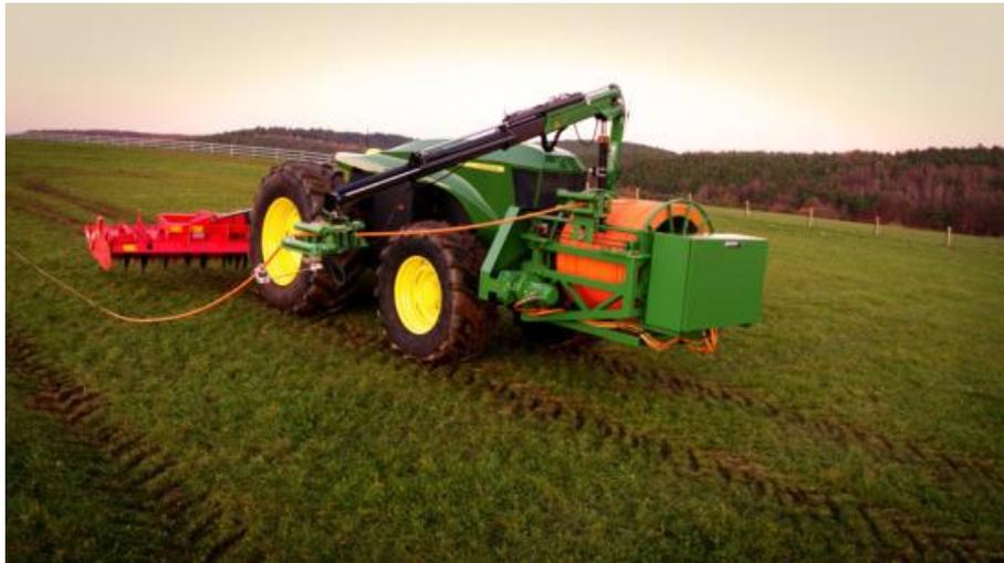
*Abbildung 2 - Noch in der Entwicklung, der autonome John Deere mit elektrischer Energieversorgung via Kabel
