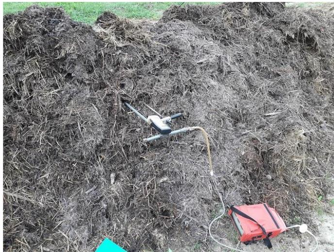
Bild 13: Mietenporenluft- und Temperaturmessung mithilfe von Messlanzen
