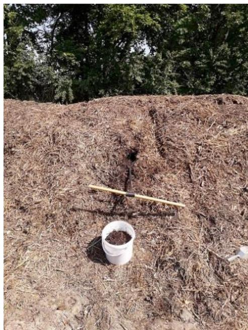
Bild 12: Entnahme der Einzelprobe aus der MC-Miete mittels Erdbohrer
