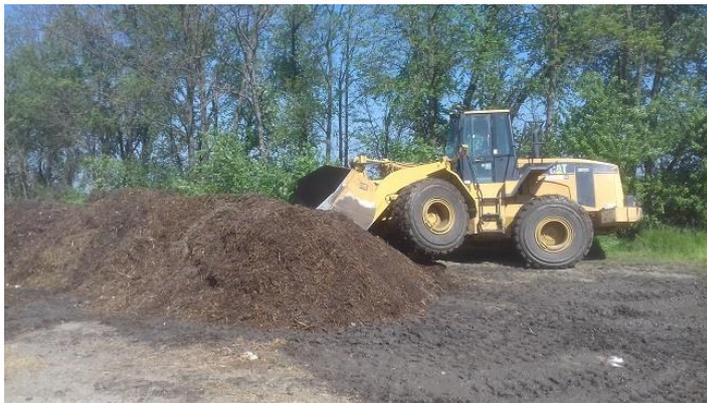
Bild 11: Verdichten der MC-Miete mittels Radlader
