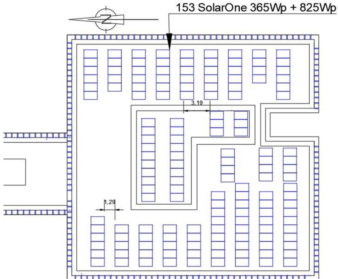
Abbildung 32: Belegung PVT-Anlage Dach Tüwi Aufsicht (AutoCAD)
