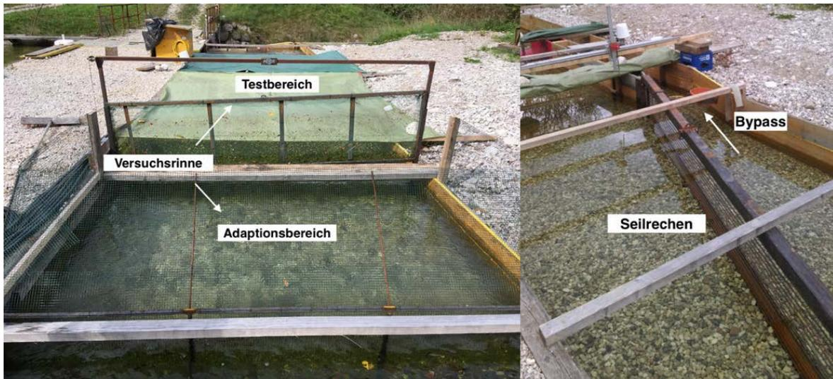
Abb. 17: Darstellung der Versuchsrinne, Blick in Richtung flussab. Linkes Bild: Adaptionsbereich mit flussabwärts gelegenen Testbereich. Rechts: Anordnung von Seilrechen und Bypass
