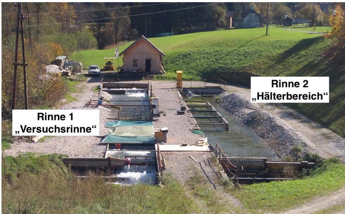
Abb. 16: Versuchsanlage HyTEC in Lunz am See, Blick in Richtung flussauf. Links: Rinne 1 als Versuchsrinne (orogr. rechte Rinne). Rechts: Rinne 2 mit Hälterbereich für die Versuchsfische (orogr. linke Rinne)
