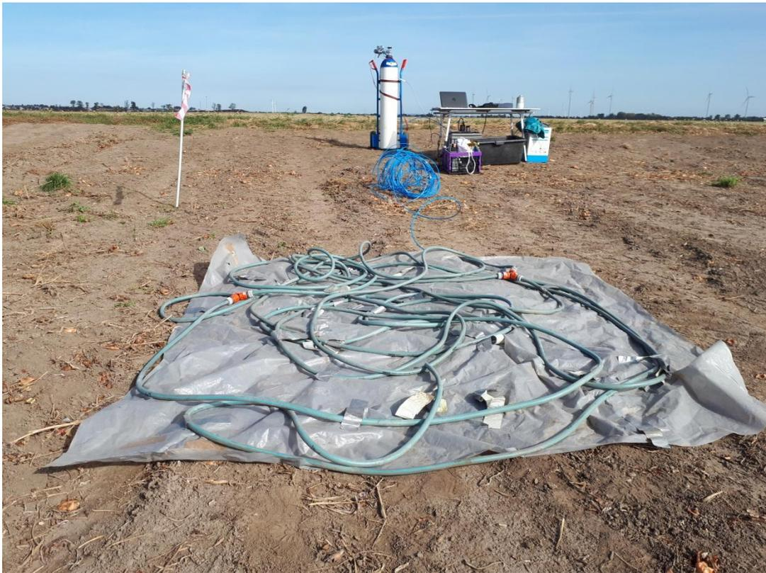
Abbildung 9: Quellenaufbau (Quelle und Prüfgas) für synthetische Freisetzungsversuche
