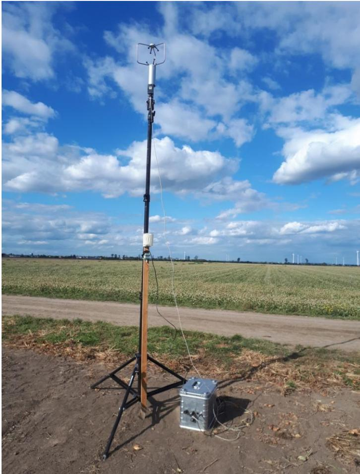
Abbildung 7: 3D-Ultraschallanemometer
