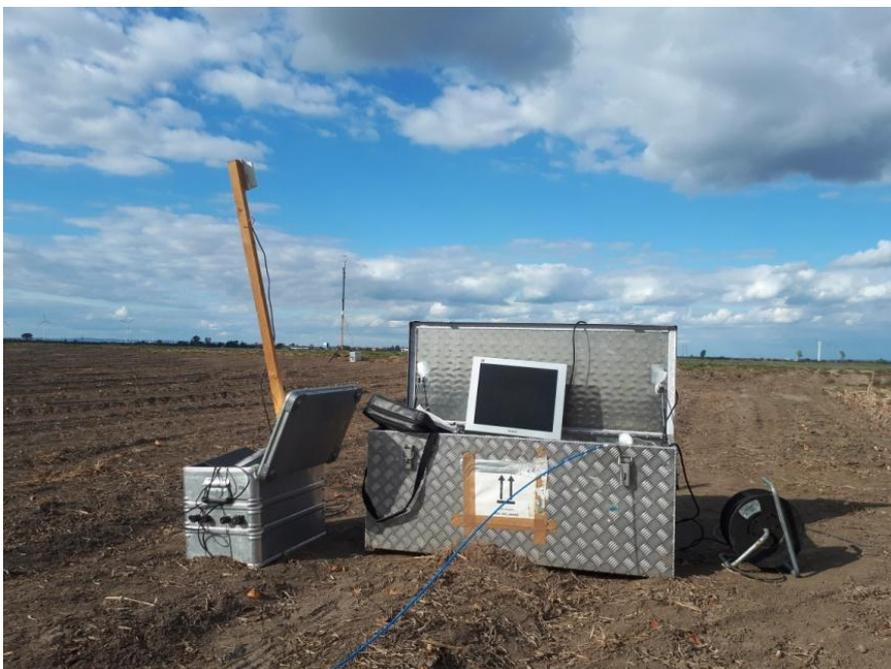
Abbildung 8:  $\text{N}_2\text{O}/\text{CO}$  Messgerät Model 907-0014 der Firma Los Gatos Research in einer Transportbox für Feldmessungen
