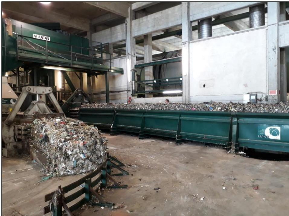
Abbildung 16: Ballenpresse der MBA-Anlage Oberpullendorf, eigene Aufnahme.
