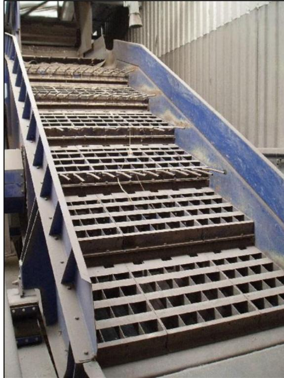
Abbildung 12: Rüttelsieb, Anlage Halbenrain (NEUBAUER und ÖHLINGER, 2006)
