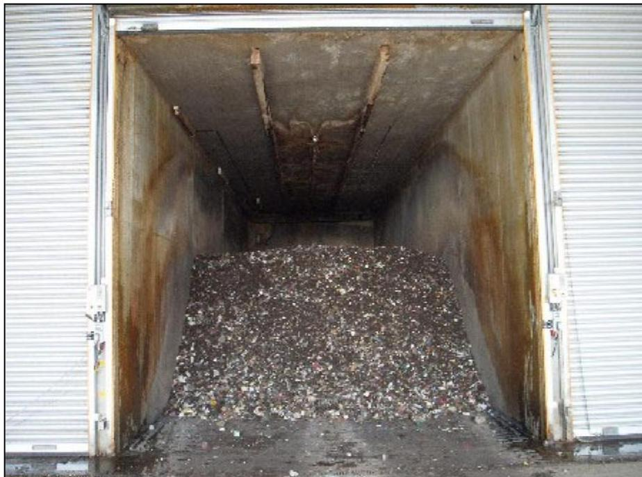
Abbildung 18: Intensivrottetunnel, Anlage Wiener Neustadt (NEUBAUER und ÖHLINGER, 2006)
