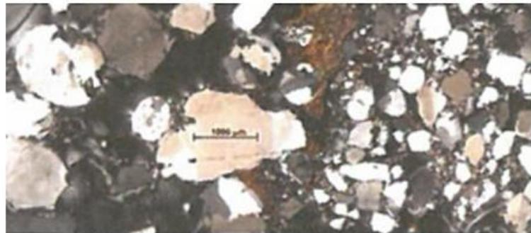
Abbildung 7.22: Struktureller Aufbau von Verockerungen im mikroskopischen Maßstab (1-eng laminierte Eisenoxide am Filterrohr, 2 u. 3-Goethit, 4-laminierte Eisenoxide auf Filterkies, Qz-Quarzkörner des Filterkies) u. Filterkuchen im Dünnschliff mit Partikelakkumulation (aus Houben & Treskatis, 2003 und Houben et al., 2017)
