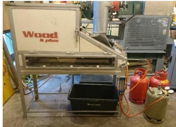
**Abb. 3: Brandprüfstand für horizontale Flächen in Anlehnung an DIN EN ISO 9239-1**
