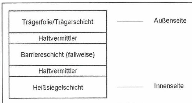
Abbildung 2: Prinzipieller Aufbau eines Aluminiumfolienverbundes (Kaßmann, 2014, 89)
