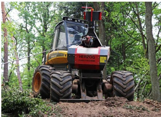
**Abbildung 4: Herzog MW500 Synchronwinch (Foto HERZOG)**
