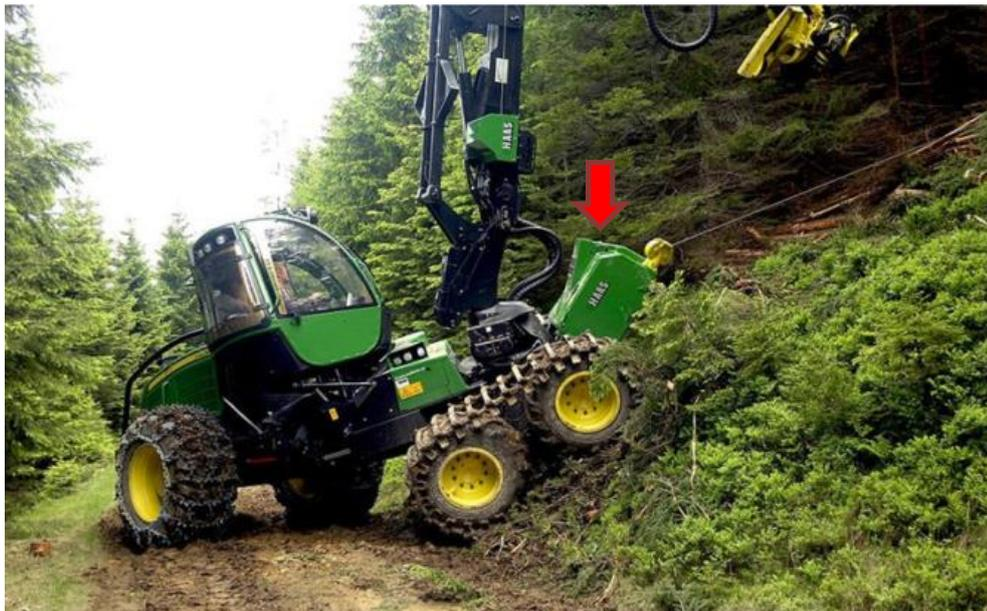
Abbildung 1: Traktionshilfsseilwinde Haas Frontaufbau (Foto HAAS)
