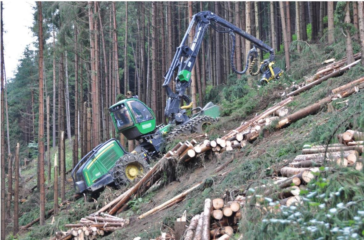
Abbildung 5: Harvester John Deere 1170E mit Traktionshilfsseilwinde der Fa. HAAS (Foto BRANDTNER)
