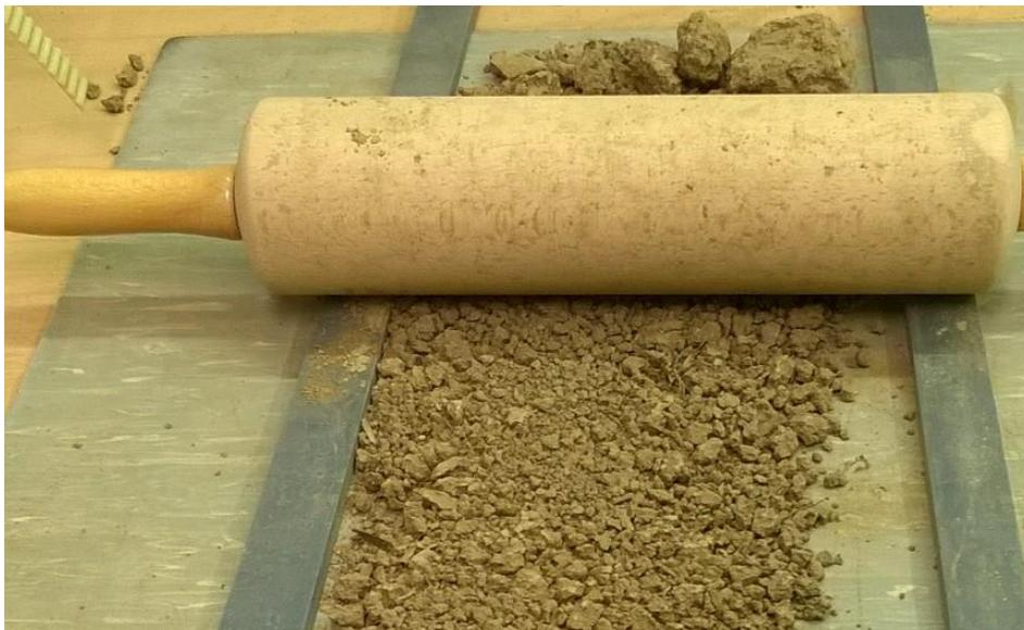
Abbildung 9 Zerkleinerung des Probenmaterials auf 8mm mithilfe eines Nudelholzes, auf zwei Kunststoffleisten geführt.
