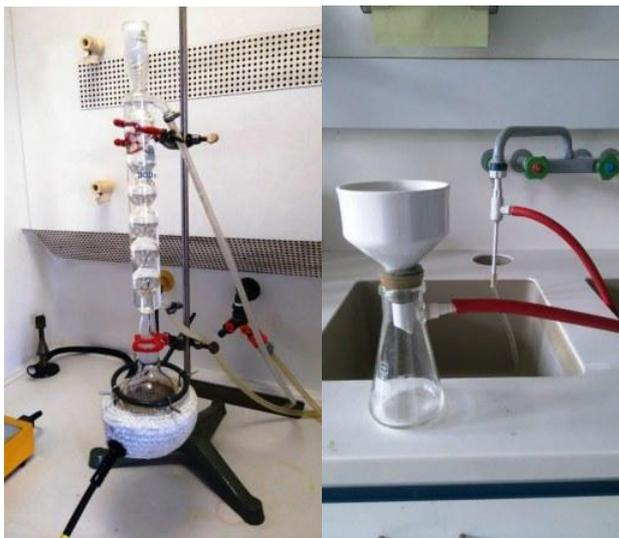
*Abbildung 7: Beheizter Rundkolben mit Birnenkühler (li.), Filternutsche mit Wasserstrahlpumpe (re.)*
