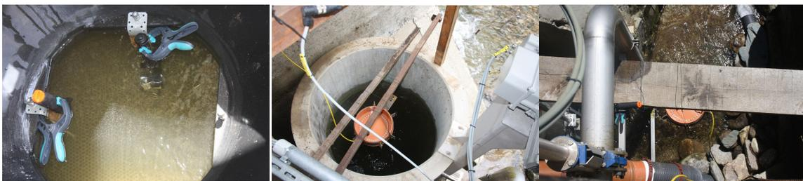
**Abbildung 10 Setup Videodokumentation: Links: 2 Go Pros im „Schwimmkörper“ montiert für Strömungsvideo und Video Automatikmodus; Mitte: Netzwerkkamera Strömungsvideo Fischliftschleusenschacht OW; Rechts: UW-Go Pro und Netzwerkkamera**
