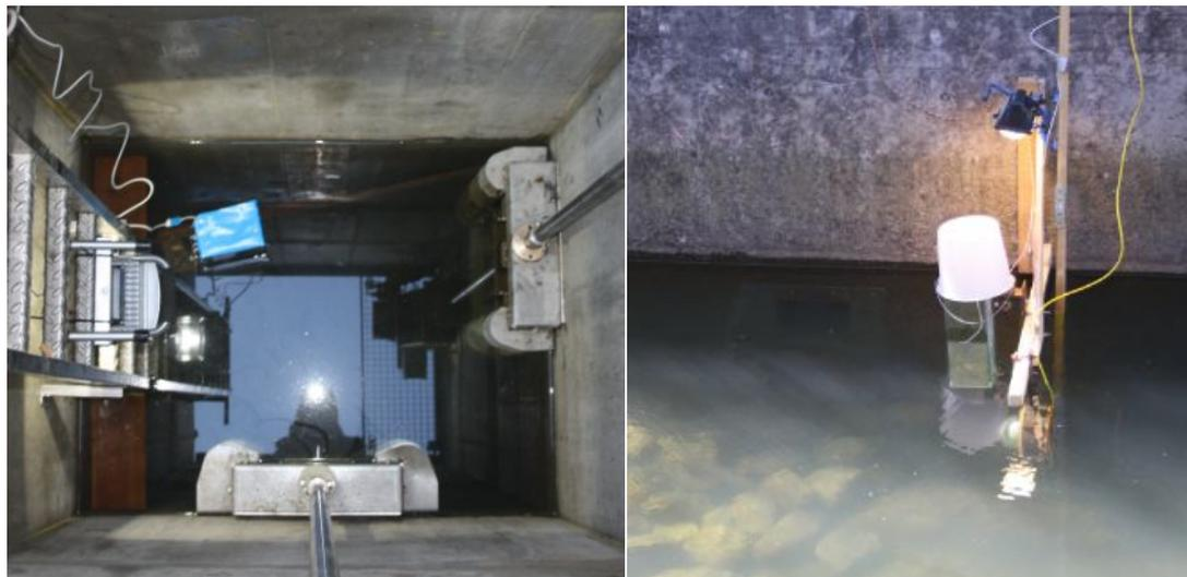
**Abbildung 11 Versuchsaufbau März 2017: Linkes Bild: Plexiglaszylinder mit 2 eingebauten GoPro Kameras und Scheinwerfer. Rechtes Bild: Netzwerkkamera, Plexigalszylinder mit eingebauter GoPro und Scheinwerfer (links neben Videosetup ist der Einstieg in den Vorkammerschacht zu sehen)**
