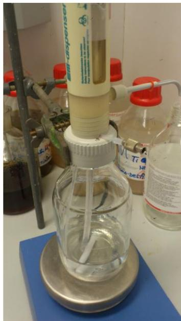
Abbildung 3: Umgebauter Dispenser mit Dosierschlauch und Luer-Lock
