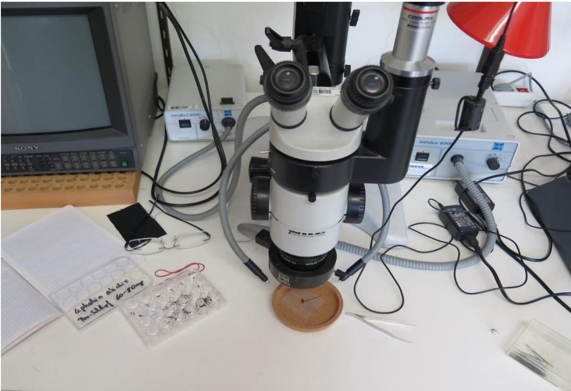
Abbildung 21: Messung der Kopfkapselbreite mit Hilfe eines Objektmikrometers unter dem Binokular.
