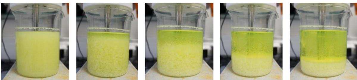
**Abbildung 14:** Bilderserie zur Sedimentation unter Elutionsbedingungen.
