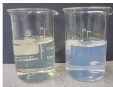
**Abbildung 10:** Überstände der Mikropartikelsuspensionen. Das Bild wurde nach Abtrennung des Großteils der Partikelfeststoffe aufgenommen. In der linken Hälfte des Bildes ist Marathon MSC und in der rechten Hälfte Marathon A2 abgebildet.
