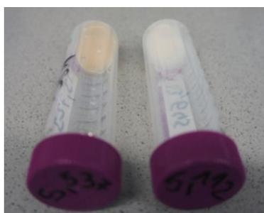
**Abbildung 9:** Mikropartikel Pellets. Entstanden sind die Pellets durch Zentrifugation während der Bestimmung des Feuchtsubstanz-Volumenanteils (links Marathon MSC und rechts Marathon A2).
