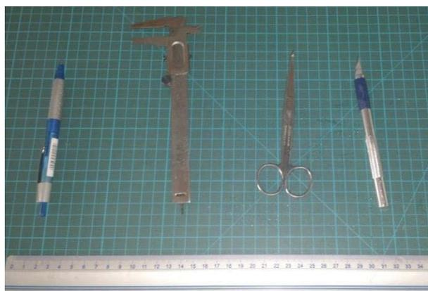
Abbildung 10 Übersicht der verwendeten Geräte für die Wurzelseparation.
