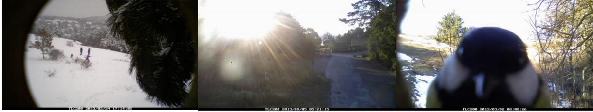
Abbildung 27: Herabhängender Ast vor der Linse am K2 am 24.02.2013; Gegenlicht am K6 am 05.08.2013; Vogel vor der Linse am K5 am 02.03.2013 (Quelle: CZACHS et al., 2014)
