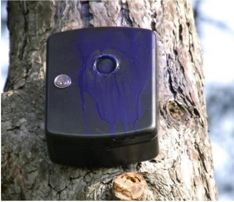
Abbildung 25: Mit Farbe besprühte Linse des Schlüsselkastens am K1 (Quelle: CZACHS et al., 2014)
