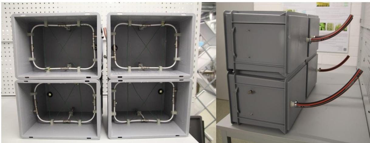
**Abb. 21 - Anbauboxen mit aeroponischem Sprühsystem**
