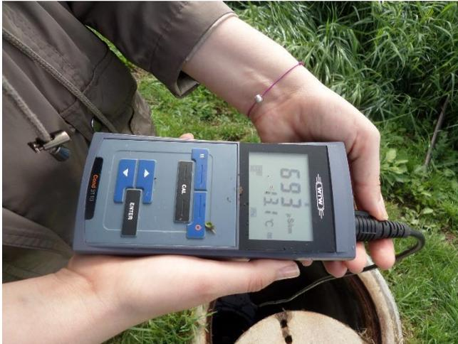
Abbildung 4-12: Leitfähigkeitsmessgerät
