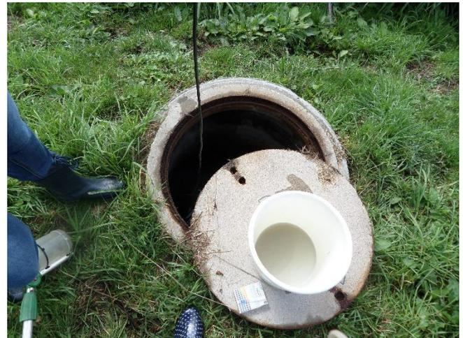
Abbildung 4-13: Messung der Leitfähigkeit
