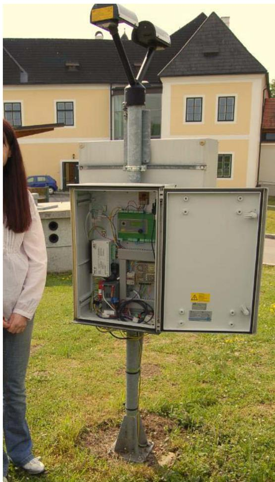
Abbildung 8: Parsivel mit Elektronikeinheit (Quelle: Strauß P.)
