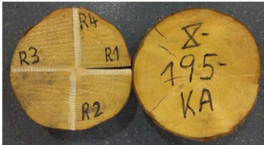
**Abbildung 2: Für die Laborarbeit präparierte Stammscheibe. Die Beschriftung zeigt die Richtung der 4 gemessenen Radien sowie den Stammscheibencode**
