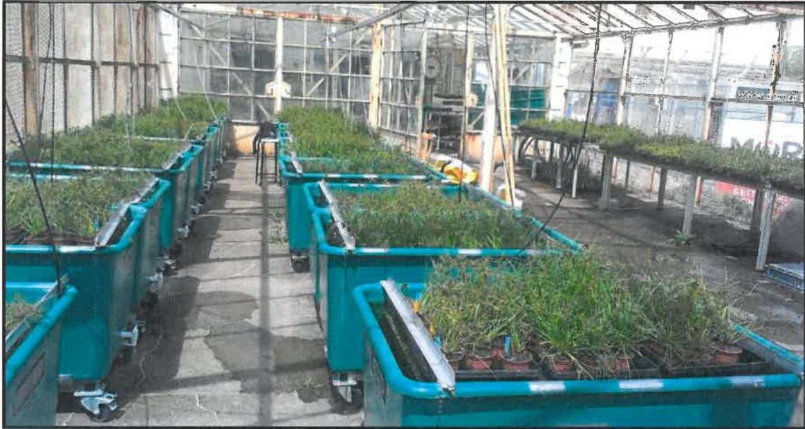
**Abbildung 3-5: Versuchsaufbau im Gitterhaus: auf den Tischen rechts befindet sich das nicht überstaute Wasserlevel 1, in den grünen Wannensystemen die Simulation des einmaligen überstauten Wasserlevels 2 bzw. des variablen Wasserlevels 3.**
